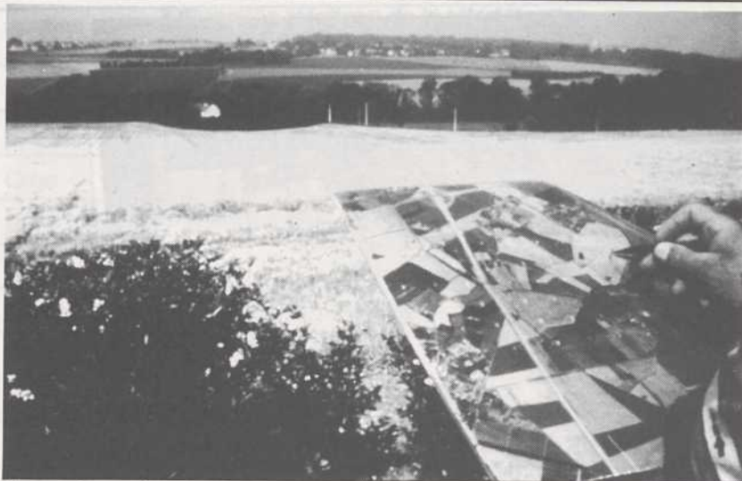
L'enquêteur dessine une parcelle, sur un transparent posé sur une photographie aérienne - Photo : SCMA
