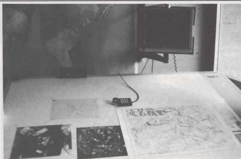
L'atelier de saisie : table à numériser, carte IGN, photo aérienne et agrandissement, transparent, curseur et écran graphique - Photo : SCEES
